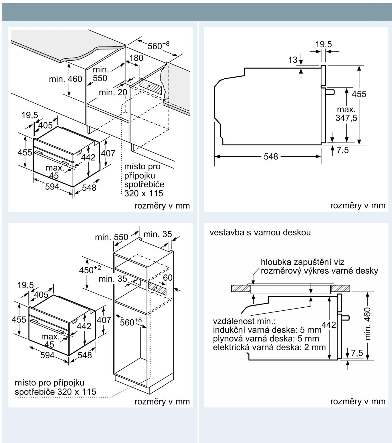
Pokud je kompaktní spotřebič vestavěný pod varnou deskou, musí být dodržena následující tloušťka pracovní desky (příp. včetně nosné konstrukce).
