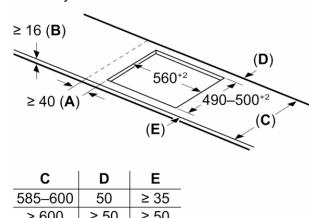
A: Min. vzdálenost od výřezu varného panelu ke stěně
