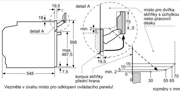
Vezměte v úvahu místo pro odklopení ovládacího panelu!
