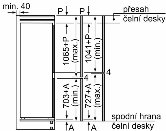
Uvedené rozměry dvírek platí pro polodrážku dvírek 4 mm.
