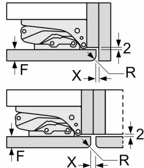
Rozměry mezer doporučené v tabulce je třeba dodržovat, aby bylo zaručeno bezproblémové otevírání dveří zařízení a nedocházelo k poškození kuchyňského nábytku.
