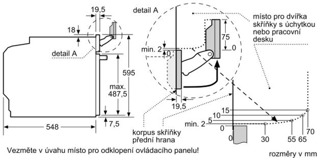
Pokud je spotřebič vestavěn pod varnou deskou, musí být dodržena následující tloušťka pracovní desky (příp. včetně nosné konstrukce).
