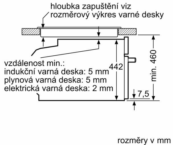
Pokud je kompaktní spotřebič vestavěný pod varnou deskou, musí být dodržena následující tloušťka pracovní desky (příp. včetně nosné konstrukce).
