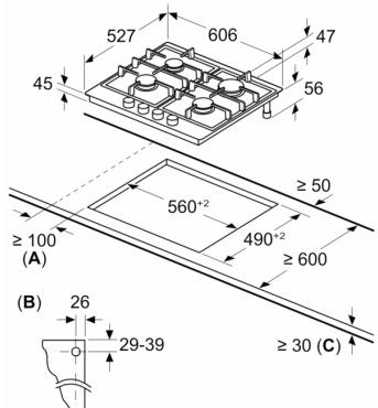
**A:** Min. vzdálenost od výřezu varného panelu ke stěně
