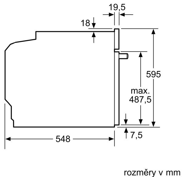
Pokud je spotřebič vestavěný pod varnou deskou, musí být dodržena následující tloušťka pracovní desky (příp. včetně nosné konstrukce).
