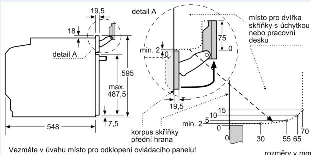
Pokud je spotřebič vestavěný pod varnou deskou, musí být dodržená následující tloušťka pracovní desky (příp. včetně nosné konstrukce).
