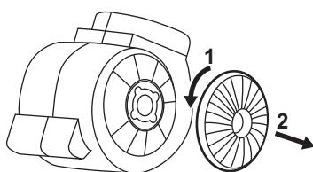
Při instalaci filtrů zpět provedte stejný postup v opačném pořadí.
