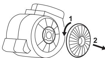
Aby z powrotem zamontować filtry, należy wykonać opisane czynności w odwrotnej kolejności.
