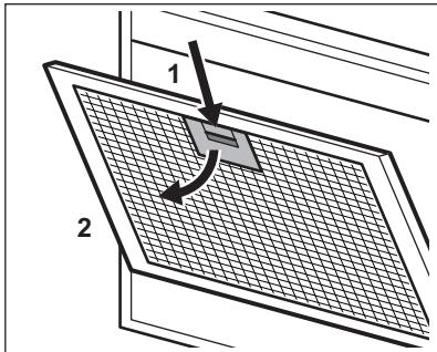
3. Inclineu lleugerament la part frontal del filtre cap avall (2) i, a continuació, estireu. Repetiu els dos primers passos per a tots els filtres.
