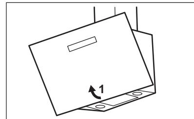
2. Drücke den Griff der Befestigungsklammer an der Filterblende unterhalb der Dunstabzugshaube (1).
