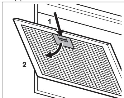
3. Incline ligeramente la parte delantera del filtro hacia abajo (2) y tire de él.
