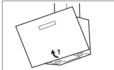
2. Davlumbazın altında bulunan filtre panelindeki montaj klipsinin tutamağına basın (1).
