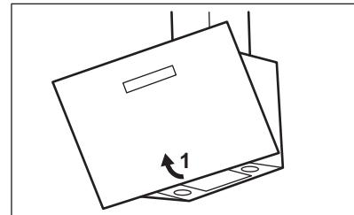
2. Premere l'impugnatura del clip di montaggio sul pannello del filtro sotto alla cappa (1).
