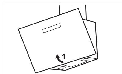
2. Premir o manípulo dos grampos de fixação no painel do filtro, por baixo do exaustor (1).
