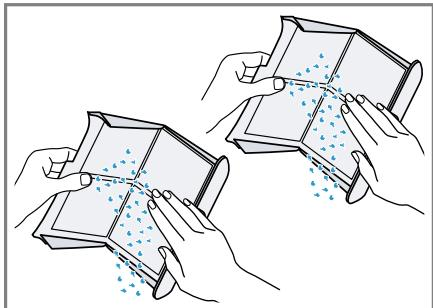
**8.** Oba filtry na žmolky důkladně vyčistěte pod tekoucí teplou vodou a osušte.
