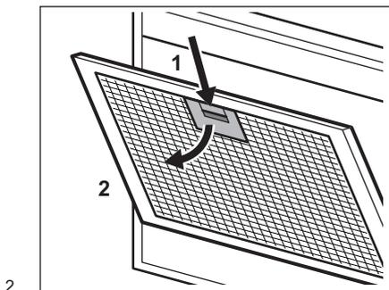
Rimozione del filtro a carbone
