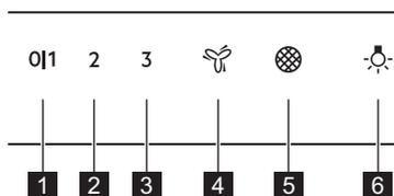
**1** **Primera velocidad/Apagada** - El motor cambia al primer nivel de velocidad. Una segunda pulsación apaga el aparato.
