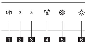
**1** **Erste Geschwindigkeit / Aus** - Der Motor schaltet auf die erste Geschwindigkeitsstufe. Erneutes Drücken schaltet das Gerät aus.
