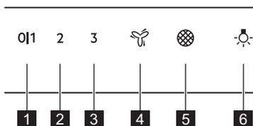
**1** **Eerste snelheid/Uit** - De motor schakelt over naar het eerste snelheidsniveau. Tweede keer drukken schakelt het apparaat uit.
