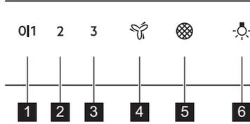
**1 İlk hız / Kapalı** - Motor ilk hız seviyesine geçer. İkinci kez basılması cihazı kapatır.
