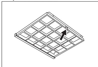
Voer de stappen in omgekeerde volgorde uit om de filter te installeren.
