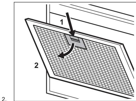
Снятие угольного фильтра
