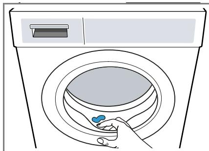
3. Nechejte dvírka spotřebiče a násypku na prací prostředky otevřené, aby mohla vyschnout zbytková voda.
