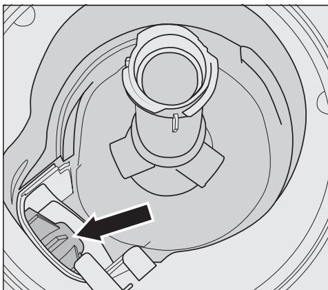
Pod krytem je umístěné vypouštěcí čerpadlo (šipka).
