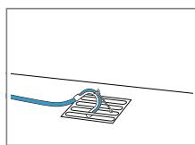
Odtokovou hadici úplně prostrčte a upevněte ji pomocí spojovacího materiálu. Koleno upevněte k podlahové vpusti.
