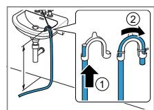
Odtokovou hadici úplně prostrčte a upevněte ji pomocí spojovacího materiálu. Koleno upevněte ve výšce maximálně 100 cm.
