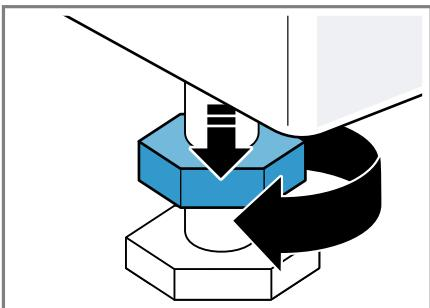
2. Pro vyrovnání spotřebiče otáčejte nožičkami spotřebiče. Vyrovnaný zkontrolujte pomocí vodováhy.
