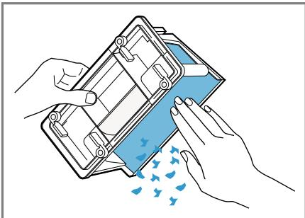
Odstraňte všechny nečistoty z těsnění.
