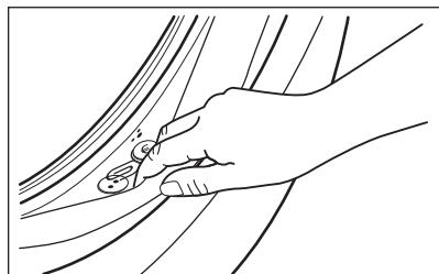
V případě potřeby těsnění očistěte pomocí čisticího prostředku na bázi čpavku tak, abyste nepoškrábali jeho povrch.
