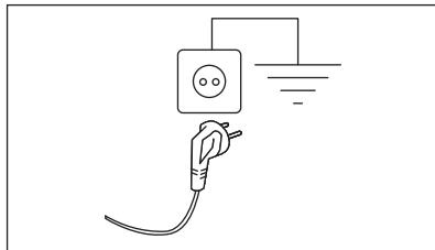
Napájecí kabel musí být po instalaci spotřebiče snadno přístupný.
