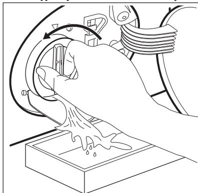
5. Jakmile je nádoba plná vody, namontujte filtr otočením zpět a nádobu vylijte.
