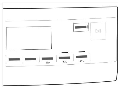
Funkci zapnete nebo vypnete stisknutím příslušného tlačítka nebo kombinace dvou tlačítek.
