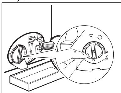
4. Otevřete filtr otočením o 180 stupňů proti směru hodinových ručiček, ale nevyjmíte ho. Nechte vodu vytéct.
