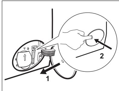
Když vypustíte vodu pomocí nouzového vypouštění, je nutné vypouštěcí systém opět aktivovat:
