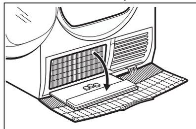
5. V prípade potreby odstráňte z kondenzátora a jeho priehradky nahromadené textilné vlákna. Môžete použiť vysávač s kefovým nástavcom.
