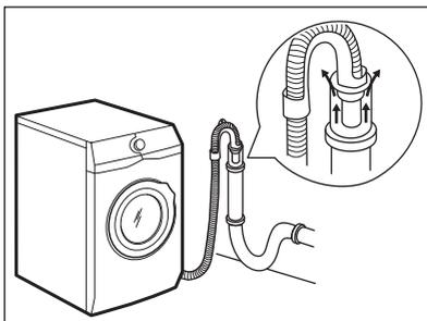
**i** Konec vypouštěcí hadice musí být stále větraný, tj. vnitřní průměr odpadního potrubí (min. 38 mm - min. 1,5") musí být širší než vnější průměr vypouštěcí hadice.
