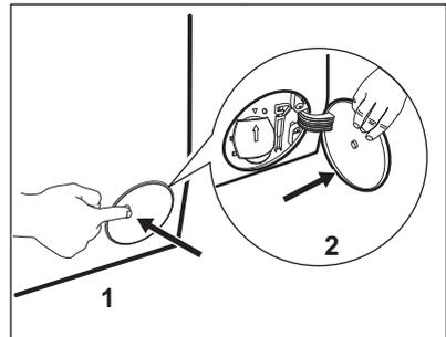
2. Položte vhodnou nádobu pod přístup k vypouštěcímu čerpadlu, abyste zachytili vytékající vodu.
