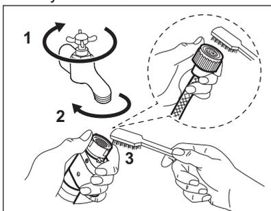
2. Odstraňte přívodní hadici ze spotřebiče povolením kruhové matice.
