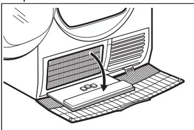
5. V případě potřeby odstraňte vlákna z kondenzátoru a jeho komory. Můžete použít vysavač s kartáčovým nástavcem.
