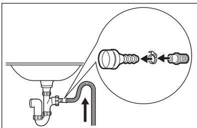
**i** Ujistěte se, že je na vypouštěcí hadici oblouk, aby se do spotřebiče nedostávala voda či nečistoty vypouštěné z umyvadla.
