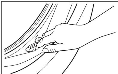
V případě potřeby těsnění očistěte pomocí čistícího prostředku na bázi čpavku tak, abyste nepoškrábali jeho povrch.
