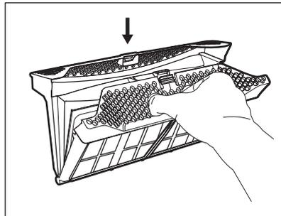
3. Z obou vnitřních částí filtru rukou vyberte vlákna.
