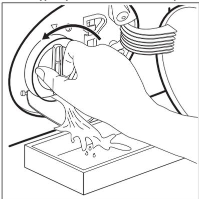
5. Jakmile je nádoba plná vody, namontujte filtr otočením zpět a nádobu vylijte.
