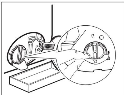
4. Otevřete filtr otočením o 180 stupňů proti směru hodinových ručiček, ale nevyjmějte ho. Nechte vodu vytéct.
