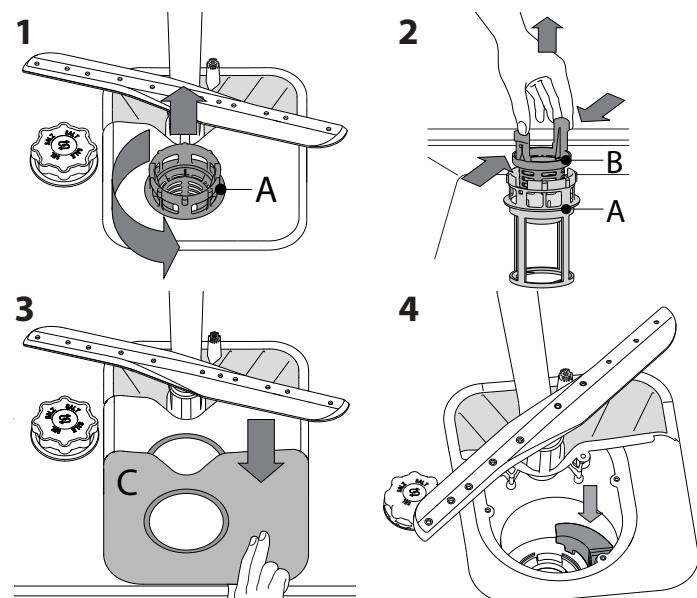
После чистки фильтров установите на место и надежно закрепите фильтрующий узел — это важно для исправной работы посудомоечной машины.
