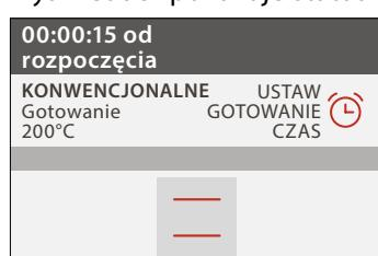
Po zakończeniu tej fazy zostanie wyemitowany sygnał dźwiękowy, a na wyświetlaczu pojawi się komunikat, że piekarnik osiągnął ustawioną temperaturę.
