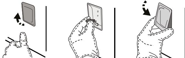
Lembre-se: Use apenas lâmpadas de halogéneo de 20-40 W/230 ~ V do tipo G9, T300 °C. A lâmpada utilizada no produto foi especificamente concebida para eletrodomésticos e não é adequada para a iluminação geral de divisões da casa (Regulamento CE 244/2009). As lâmpadas estão disponíveis no nosso Serviço Pós-Venda.
