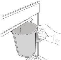
In jedem Fall wird diese Maßnahme nach einer bestimmten Anzahl an Garvorgängen zwingend erforderlich und es kann keine Dampffunktion gestartet werden, bevor dies ausgeführt wurde.
