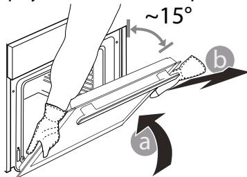
Vuelva a instalar la puerta llevándola hacia el horno, alineando los ganchos de las bisagras con sus alojamientos y fijando la parte superior en su alojamiento.
