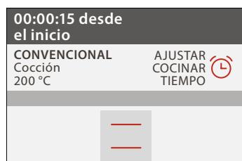
Cuando el precalentamiento haya terminado, sonará una señal acústica y la pantalla indicará que el horno ha alcanzado la temperatura establecida.
