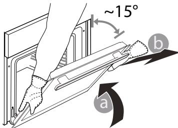
**Reponha a porta**, deslocando-a na direção do forno e alinhando os ganchos das dobradiças com os respetivos suportes, fixando a parte superior aos suportes.
