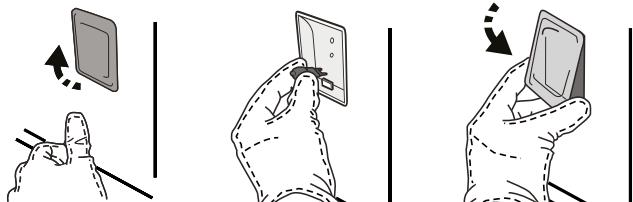
Veuillez noter : Utilisez uniquement des ampoules halogènes de 20-40 W/230 V~, type G9, T300 °C. L'ampoule utilisée dans le produit est spécifiquement conçue pour des appareils domestiques et n'est pas adaptée pour un éclairage général de la pièce dans la maison (Réglementation CE 244/2009). Ces ampoules sont disponibles auprès de notre Service après-vente.
