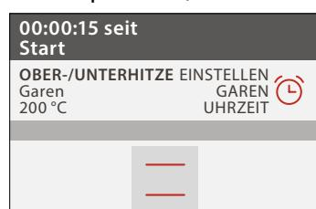
Sobald diese Phase beendet wurde, ertönt ein akustisches Signal und das Display zeigt an, dass der Backofen die eingestellte Temperatur erreicht hat.
