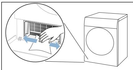
**Upozornění:** Dbejte na to, abyste nepoškodili volně přístupný výměník tepla.
