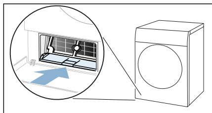
11. Zasuňte kryt výměníku tepla za držadlo.
