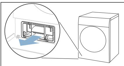
6. Filtračnú vložku opatrne vytiahnite z krytu výmenníka tepla.
