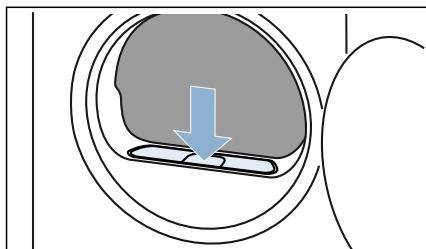
7. Vlákna spláchnite pod teplou tečúcou vodou.
