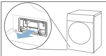
6. Opatrně vytáhněte filtrační vložku z krytu výměníku tepla.
