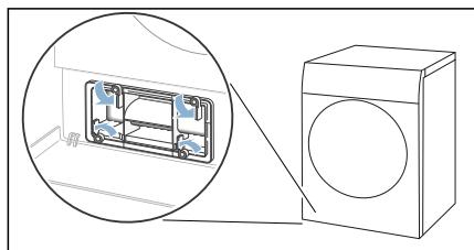
5. Vytáhněte kryt výměníku tepla za držadlo.
