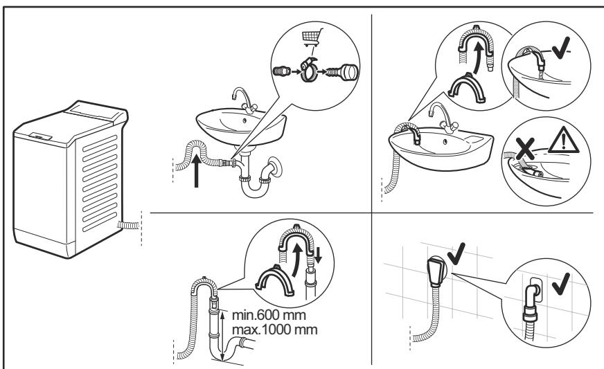
Priamo do odtokového potrubia vo výške aspoň 600 mm a najviac 1 000 mm.
