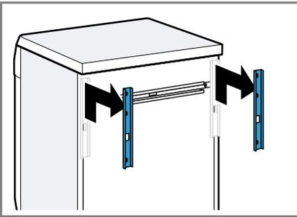
3. Skrutky horizontálnej prepravnej priečky povoľte skrutkovačom T20 a odstráňte.
