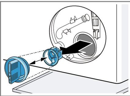
2. Vyčistite vnútorný priestor, závit veka čerpadla a teleso čerpadla.
