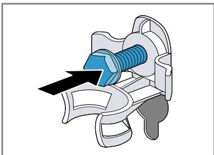
4. Sieťové prírodné vedenie upevnite do držiaka ① a povoľte všetky 4 skrutky prepravných poistiek skrutkovým kľúčom veľkosti 13 ②.
