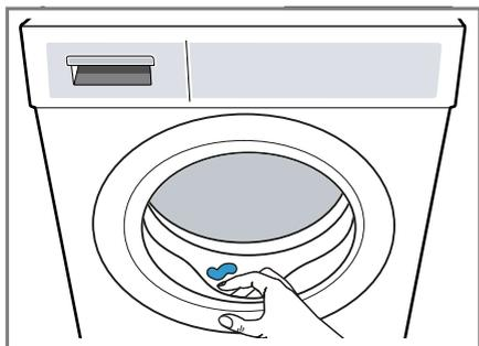
3. Nechejte dvířka a násypku na prací prostředky otevřená, aby mohla vyschnout zbytková voda.
