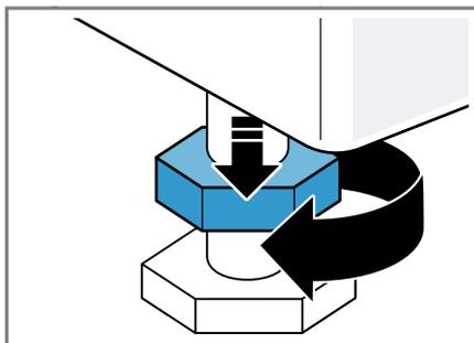
2. Pro vyrovnaní spotřebiče otáčejte nožičkami spotřebiče. Vyrovnaní zkontrolujte pomocí vodováhy.
