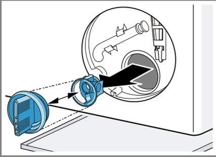
2. Vyčistěte vnitřní prostor, závit víčka čerpadla a těleso čerpadla.
