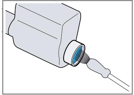
3. Pripojte prívodnú hadicu vody a skontrolujte, či je spojenie utesnené.
