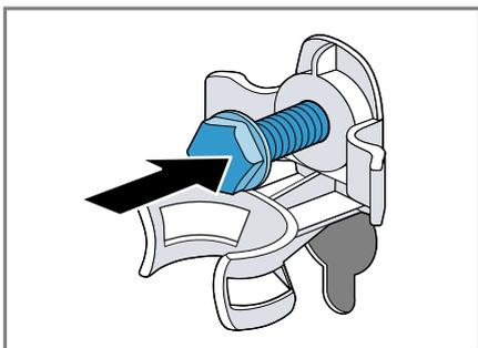
4. Síťový kabel nasadte do držáku ① a všechny 4 šrouby přepravních pojistek dotáhněte šroubovákem vel. 13 ②.
