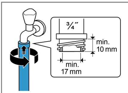
3. Opatrně otevřete přívod vody a zkontrolujte těsnost připojovacích míst.
