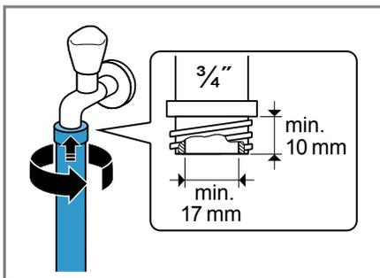
3. Otvorte opatrne vodovodný kohútik a skontrolujte tesnosť pripojovacích miest.
