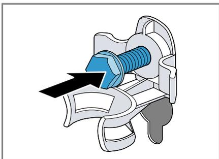
4. Sieťové prívodné vedenie upevnite do držiaka ① a povoľte všetky 4 skrutky prepravných poistiek skrutkovým kľúčom veľkosti 13 ②.
