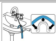
Odtok do plastovej rúry s gumovým hrdlom. Odtokovú hadicu vody zafixujte a zistite obľúkom.
