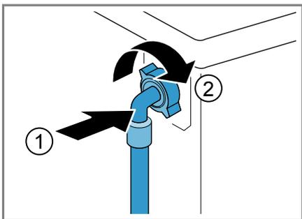
2. Pripojte prívodnú hadicu vody na prívod vody (26,4 mm = 3/4").
