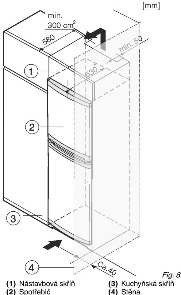
\* U přístrojů s přiloženými vymezovači odstupu od stěny se rozměr zvětší o 35 mm (viz 4.2 Ustavení přístroje).
