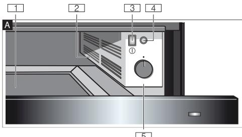
**[1] Povrch s protiskluzovou podložkou**
