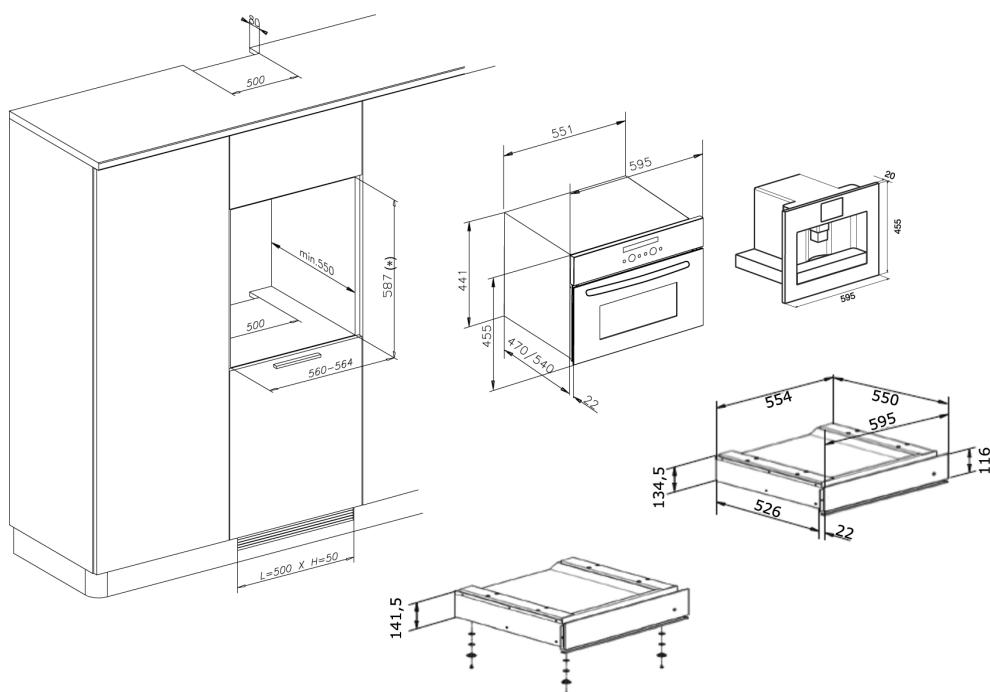
( \*) Jos kalustekaapin korkeus on 595 mm, laatikon alaosaan on asennettava neljä jalkaa sekä vastaavat 1 mm:n aluslaatat (sisältyvät pakkaukseen).
