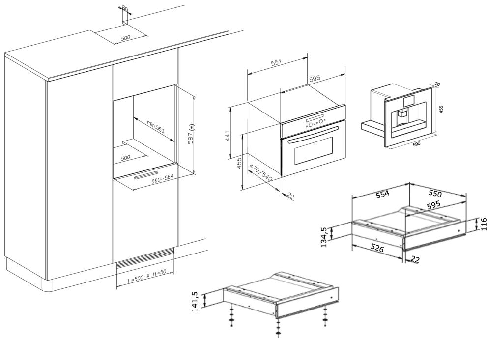
( \*) Si la hauteur de la niche est de 595 mm, le tiroir doit être installé avec les 4 pieds et leurs rondelles de 1 mm (inclus dans l'emballage) dans la partie inférieure.
