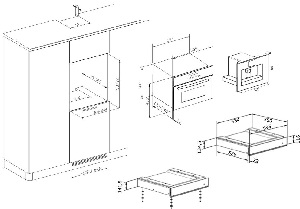
( \* ) No caso de um armário com a altura de compartimento 595, a gaveta deverá ser instalada com os 4 pés e as respectivas anilhas de 1 mm (incluídas na embalagem) na parte inferior.
