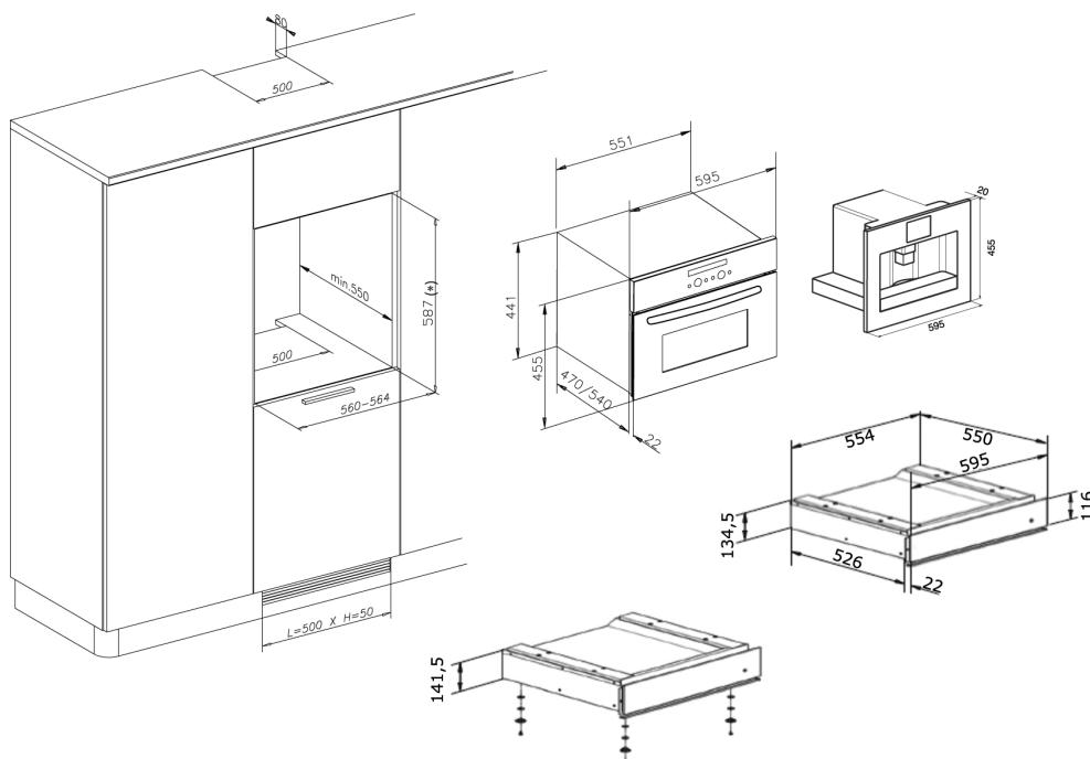
( \* ) В случае ниши для встраивания в кухонной мебели высотой 595 мм подогреватель посуды должен устанавливаться в ее нижней части на 4 ножках с соответствующими шайбами высотой 1 мм (входящими в комплект поставки).
