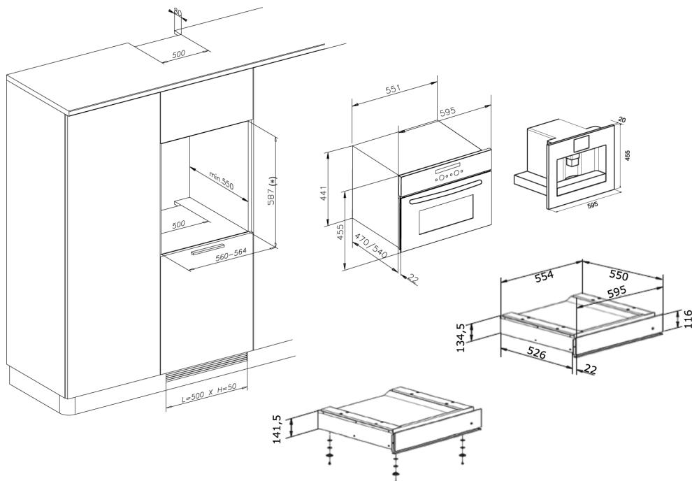
( \*) Med en urtagshöjd på 595 mm hos köksskåpet måste lådan installeras med de 4 fotterna och respektive 1 mm brickor (medföljer i förpackningen) i den nedre delen.
