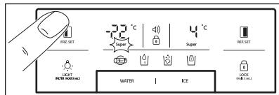
Para ajustar la temperatura pulse la tecla **FRZ. SET** hasta que aparezca el valor deseado. Para congelación rápida, pulse la tecla **FRZ. SET** hasta que se ilumine el LED. Para detener la función, vuelva a pulsar la tecla.
