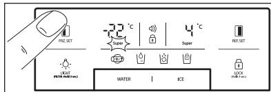
Za nastavitev temperature pritisnite tipko **FRZ. SET**, dokler se ne prikaže želena vrednost. Za funkcijo hitrejšega zamrzovanja držite tipko **FRZ. SET** pritisnjeno, dokler ne zasveti svetleča dioda »super«. Za zaustavitev te funkcije ponovno pritisnite tipko.
