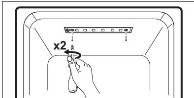
3. Desligue os fios da placa e substitua a iluminação LED.
