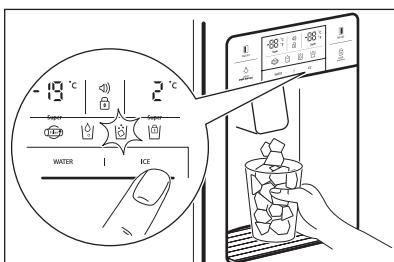
Cuando limpie el montaje de la caja de cubitos o no lo utilice durante mucho tiempo, quite los cubitos de la caja de almacenamiento de hielo y bloquee la fabricación de hielo pulsando el botón ICE durante 3 segundos. se encenderá.
