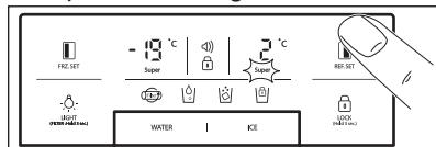
Para ajustar la temperatura pulse la tecla **REF. SET** hasta que aparezca el valor deseado. Para enfriamiento rápido, pulse la tecla **REF. SET** hasta que se ilumine el LED. Para detener la función, vuelva a pulsar la tecla.
