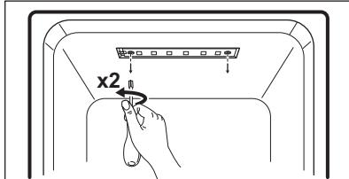
3. Разкачете ремъците на светодиодната пластина и
