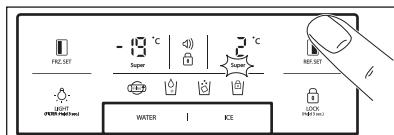
Ak chcete nastaviť teplotu, stlačajte tlačidlo **REF. SET** až kým sa nezobrazí požadovaná hodnota. Ak chcete zapnúť funkciu Rýchlejšie chladenie, podržte tlačidlo **REF. SET**, až kým sa nerozsvieti LED indikátor Super. Ak chcete túto funkciu vypnúť, stačí znova stlačiť tlačidlo.
