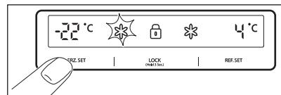
Za nastavitev temperature pritisnite tipko **FRZ. SET**, dokler se ne prikaže želena temperatura. Za funkcijo hitrejšega zamrzovanja držite tipko **FRZ. SET** pritisnjeno, dokler ne zasveti svetleča dioda »Super«. Za zaustavitev te funkcije ponovno pritisnite tipko.
