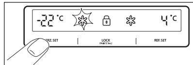
W celu ustawienia temperatury należy nacisnąć przycisk **FRZ. SET**, aż zostanie wyświetlona żądana wartość temperatury. Aby włączyć funkcję szybkiego zamrażania, należy nacisnąć i przytrzymać przycisk **FRZ. SET**, aż zaświeci się wskaźnik „Super”. Aby wyłączyć tę funkcję, należy ponownie nacisnąć przycisk.
