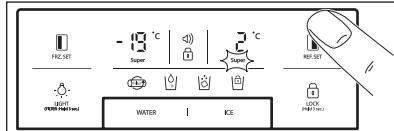
Для установки температуры нажмите на кнопку **REF. SET** до появления нужного значения. Для ускоренного охлаждения нажмите и удерживайте кнопку **REF. SET**, пока не загорится индикатор «Супер». Для отмены режима просто снова нажмите на кнопку .
