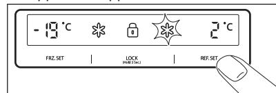
За настройка на температурата натиснете бутона **REF. SET**, докато се включи силен светодиод.
