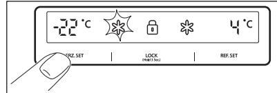
Для установки температуры нажмите на кнопку **FRZ. SET** до появления на дисплее нужной температуры. Для ускоренного замораживания нажмите и удерживайте кнопку **FRZ. SET**, пока не загорится индикатор «Супер». Для отмены режима просто снова нажмите на кнопку .
