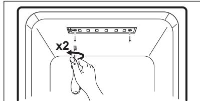
3. Atjunkite šviesos diodų plokštelię elektros laidus ir pakeiskite šviesos diodą.
