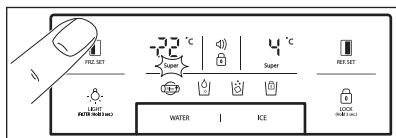
Sıcaklık ayarı için, istenilen değer görünene dek **FRZ. SET** tuşuna basın. Daha Hızlı Dondurma fonksiyonu için, super LED'i yanana dek **FRZ. SET** tuşunu basılı tutun. Bu fonksiyonu durdurmak için tuşa yeniden basın.
