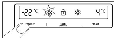
Ak chcete nastaviť teplotu, stlačajte tlačidlo **FRZ. SET** až kým sa nezobrazí požadovaná hodnota. Ak chcete zapnúť funkciu Rýchlejšie zmrazenie, podržte tlačidlo **FRZ. SET** až kým sa nerozsvieti LED indikátor Super. Ak chcete túto funkciu vypnúť, stačí znova stlačiť tlačidlo.
