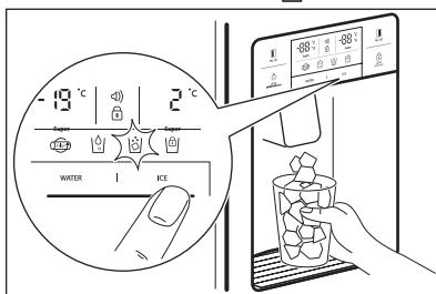
При очистке емкости для кубиков льда или после длительного ее неиспользования удалите кубики льда из емкости для их хранения и заблокируйте льдогенератор, нажав на кнопку ICE («Лед») и удерживая ее 3 секунды. Высветится символ
