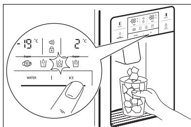
Pri čistení zásuvky na kocky ľadu alebo ak ste ju dlhší čas nepoužívali, vyberte kocky ľadu zo skladovej zásuvky na Tad a zablokujte výrobník ľadu tak, že stlačíte tlačidlo ICE a podržíte ho 3 sekundy. Rozsvieti sa symbol.
