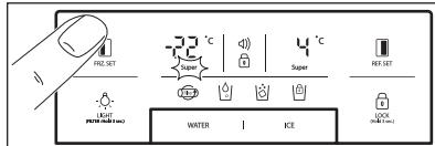
Для установки температуры нажмите на кнопку **FRZ. SET** до появления нужного значения. Для ускоренного замораживания нажмите и удерживайте кнопку **FRZ. SET**, пока не загорится индикатор «Супер». Для отмены режима просто снова нажмите на кнопку .
