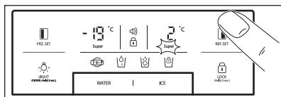
Sıcaklık ayarı için, istenilen değer görünene dek **REF. SET** tuşuna basın. Daha Hızlı Soğutma fonksiyonu için, super LED'i yanana dek **REF. SET** tuşunu basılı tutun. Bu fonksiyonu durdurmak için tuşa yeniden basın.
