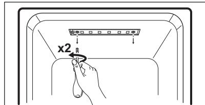
3. Desconecte los cables de la placa LED y cambie el LED.
