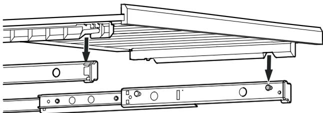
Vysouvací kolejnice zcela vytáhnout. Nasadit dřevěný rošt s předními prohloubeninami na přídržovací čepy.
