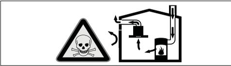
Zdroje topení závislé na přívodu vzduchu z místnosti (např. topná tělesa na plyn, olej, dřevo nebo uhlí, průtokové ohřivače, bojler) odebírají spalovací vzduch z místnosti, ve které jsou nainstalované, a spaliny odvádějí zařízením pro odvod spalin (např. komínem) ven.
