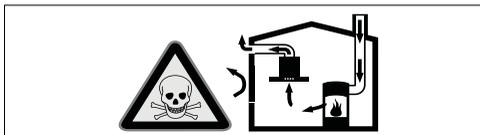
Ohniská závislé od vetrania miestnosti (napr. vyhrievacie spotrebiče na plyn, olej, drevo alebo uhlie, prietokové ohrievače, ohrievače vody) odoberajú dymové plyny z miestnosti, kde sú nainštalované a odvádzajú ich odsávacím zariadením (napr. komín) von.
