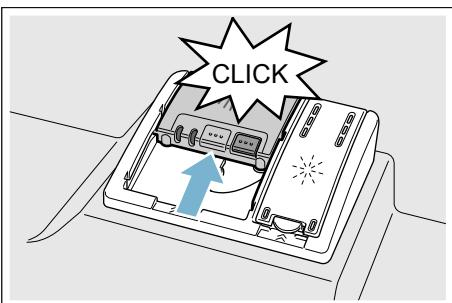
Zásobník na mycí prostředek se v závislosti na programu automaticky otevře v optimální časový okamžik. Práškový nebo tekutý mycí prostředek se v přístroji postupně rozpustí. Tableta spadne do záhytné mísky na tablety, kde se postupně rozpustí.
