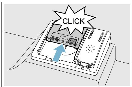
Zásobník na umývací prostriedok sa otvára v závislosti od programu automaticky v optimálny čas. Práškový alebo tekutý umývací prostriedok sa v prístroji postupne rozpustí. Tableta spadne do záchrnej misky na tabletu, kde sa postupne rozpustí.
