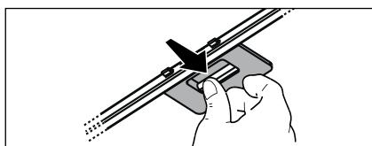
**Filtr węglowy NIE nadający się do mycia.** Nasycenie filtra następuje po krótkim lub dłuższym okresie użytkowania w zależności od rodzaju kuchni i od regularności z jaką jest wykonywane czyszczenie filtru tłuszczykowego. Wkład filtra powinien być w
