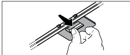
**Filtro al carbón activo NO lavable** - La saturación del carbón activado ocurre después de mas o menos tiempo de uso prolongado, dependiendo del tipo de cocina y de la regularidad de limpieza del filtro de grasa. En cualquier caso es necesario sustituir el cartucho al menos cada 4 meses. NO puede lavarse o reciclarse.
