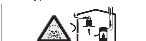
Kúreniská so závislošťou od okolitého vzduchu (napr. ohrievače na plyn, olej, drevo alebo uhlí, prietokové ohrievače, teplovodné ohrievače) ohrevajú spalinový vzduch v mieste inštalácie a odvádzajú odpadové plyny cez odvodné zariadenie (napr. komín) von.
