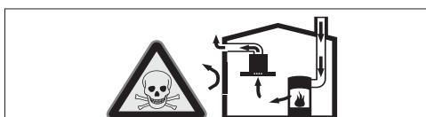
Topeniště se závislostí na okolním vzduchu (např. ohřívače na plyn, olej, dřevo nebo uhlí, průtokové ohřívače, bojillery) ohřívají spalinový vzduch v místě instalace a odvádí odpadní plyny skrze odvodní zařízení (např. komín) ven.
