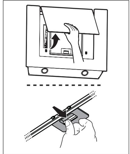
**4.2 Der NICHT waschbare Aktivkohlefilter** - Je nach der Benetzungsdauer des Herdes und der Häufigkeit der Reinigung des Fettfilters tritt nach einer mehr oder weniger langen Benetzungsdauer die Sättigung des **Aktivkohlefilters** auf. Auf jeden Fall muß der Filtereinsatz mindestens alle 4 Monate ausgewechselt werden. Er kann NICHT gereinigt oder erneut aktiviert werden.
