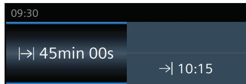
3. Tlačítkem start/stop spusťte přístroj. Doba trvání →| se viditelně odměřuje na stavovém rádku.
