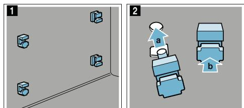
3. Držák vzadu zavěste hákem do horního otvoru **a** a zatlačte do dolního otvoru **b** (obrázek 3).
