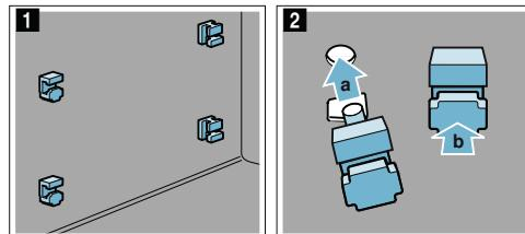
3. Držiak vzadu zaveste háčikom do horného otvoru **a** a zatlačte do dolného otvoru **b** (obrázok 3).
