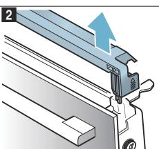
**Upozornenie:** Vložku z nehrdzavejúcej ocele v kryte vyčistite čistiacim prostriedkom na nehrdzavejúcu ocel. Zvyšok krytu dvierok vyčistite teplým umývacím roztokom a mäkkou handričkou.
