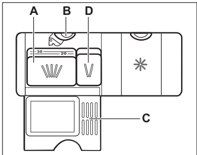
1. Stiskněte uvolňovací tlačítko (B) a otevřete víko (C).
