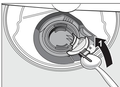
6. Zkontrolujte oběžné kolo na cizí tělesa a případně je odstraňte.
