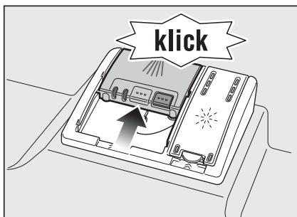
Komora pro mycí prostředek se v závislosti na programu automaticky otevře v optimální časový okamžik. Práškový nebo tekutý mycí prostředek se ve spotřebiči rozdělí a rozpustí, tableta spadne do záhytné misky na tablety a dávkovaně se zde rozpustí.
