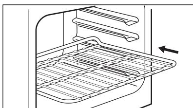
Zasuňte rošt do příslušné polohy. Ujistěte se, že se nedotýká zadní stěny trouby.
