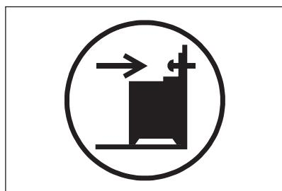
1. Nainstalujte ochranu proti překlopení ve výšce 317 - 322 mm pod úrovní horní pracovní plochy a 80 - 85 mm od strany spotřebiče skrze kruhový otvor na konzole. Přišroubujte jej do pevného materiálu nebo použijte vhodnou oporu (zed').
