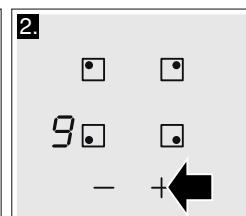
3. Změna stupně vaření: Dotýkejte se symbolu + nebo -, dokud se nezobrazí požadovaný stupeň vaření.
