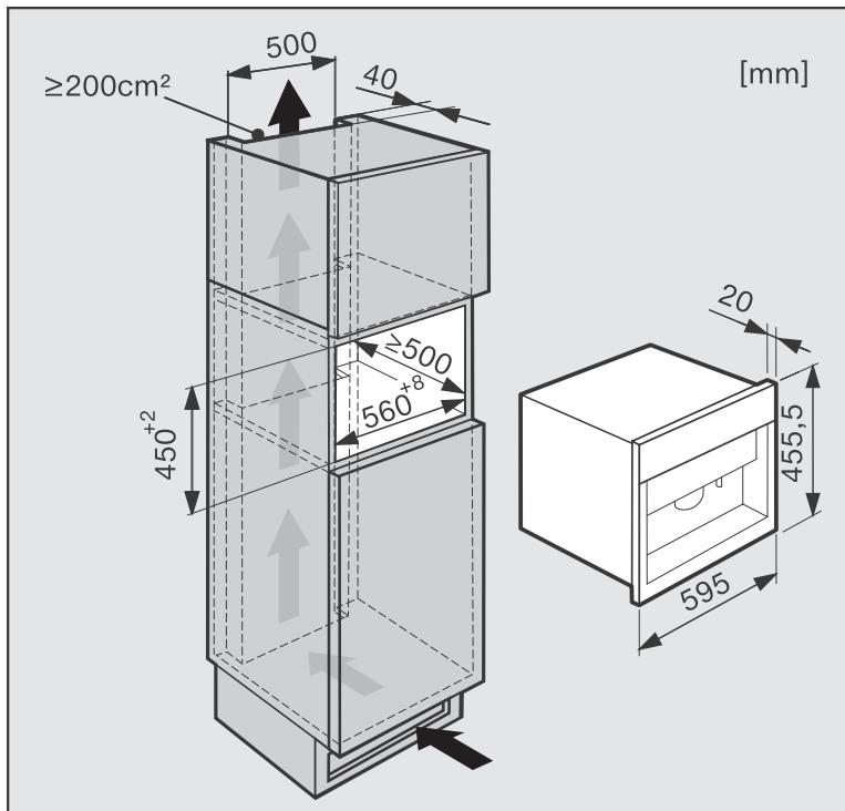
Je možná kombinace s jinými vestavnými přístroji Miele. Je přitom ovšem velmi důležité, aby byl přístroj dole oddělený uzavřeným vloženým dnem (kromě kombinace s vestavným nahříváčem nádobí / ohříváčem jídel).
