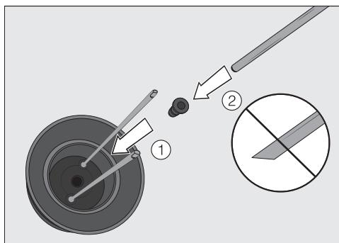
Dbejte na to, abyste do těsnění **ne-nasadili** zešíkmený konec nerezové trubky. Těsnění by se tím poškodilo.
