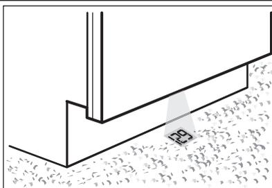
System **TimeBeam** emituje wiązkę światła wyświetlającą informacje na podłodze, pod drzwiami urządzenia.
