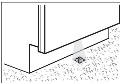
**TimeBeam** је дисплеј који се приказује на поду испод врата уређаја.
