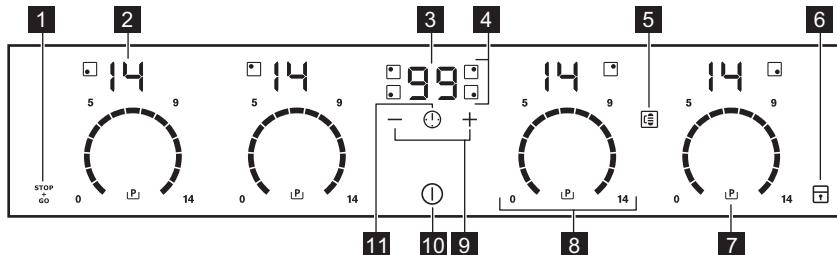
Aby sa zobrazil ovládací panel, zapnite spotrebič pomocou ①.
