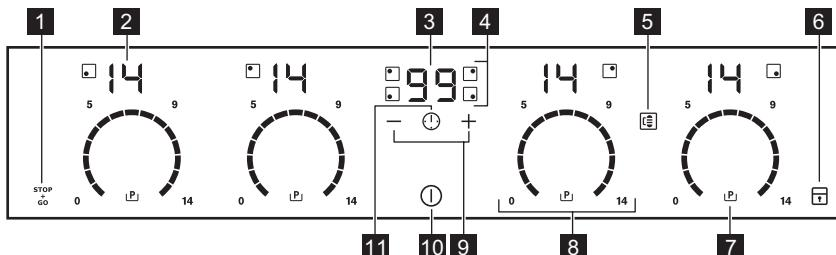
Aby wyświetlić panel sterowania, należy włączyć urządzenie za pomocą ①.
