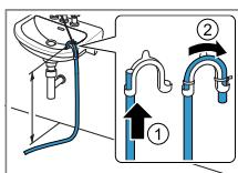
Odtokovou hadici úplně prostrčte kolenem a upevněte ji pomocí spojovacího materiálu. Koleno upevněte ve výšce maximálně 100 cm.
