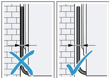
Dbejte na to, abyste hadice a přívodní kabel neuskřípli mezi stěnou a spotřebičem.
