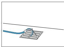
Odtokovou hadici úplně prostrčte kolenem a upevněte ji pomocí spojovacího materiálu. Koleno upevněte k podlahové vpusti.
