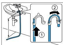
Odtokovou hadici úplně prostrčte kolenem a upevněte ji pomocí spojovacího materiálu. Koleno upevněte ve výšce maximálně 100 cm.
