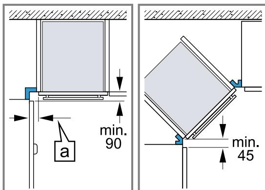
Aby bylo možno otevírat dvířka spotřebiče, je nutné při vestavbě do rohu dodržet minimální rozměry. Rozměr **a** závisí na tloušťce přední hrany skříňky a na madle.
