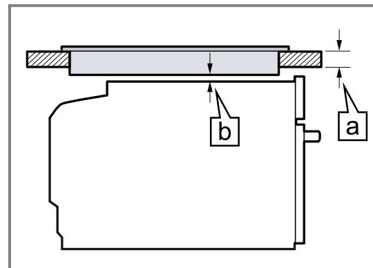
Na základě potřebné minimální vzdálenosti **b** vyplývá minimální tloušťka pracovní desky **a**.
