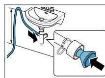
Zajistěte místo připojení hadicovou sponou (12–22 mm). Odtokovou hadici upevněte pomocí držáku hadice ve výšce minimálně 80 cm a maximálně 100 cm.
