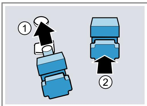
3. Zadní držáky s hákem zavěste do horního otvoru ① a zatlačte do dolního otvoru ②.
