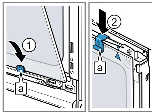
4. Přední sklo zahákněte dole do levého a pravého držáku [a] ①.
