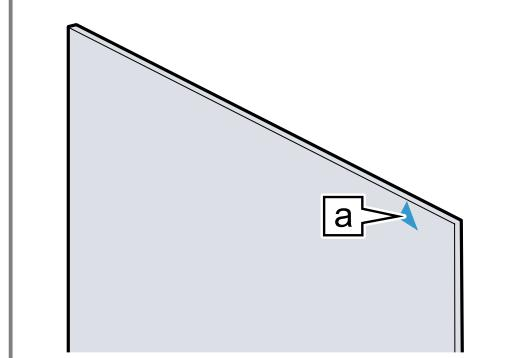
2. Mezisklo nasadte dole do držáku [a] ① a nahoře ho přitlačte a přidržujte.
