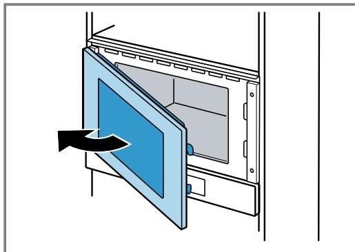
**4. Przykręcić urządzenie do mebla po przeciwnej stronie zawiasów.**
